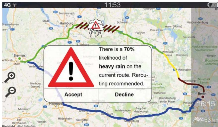
Abbildung 3.2: Wetterbasiertes Navigationssystem mit Angabe der Präzision der Wettervorhersage [Kla17, S. 2]
